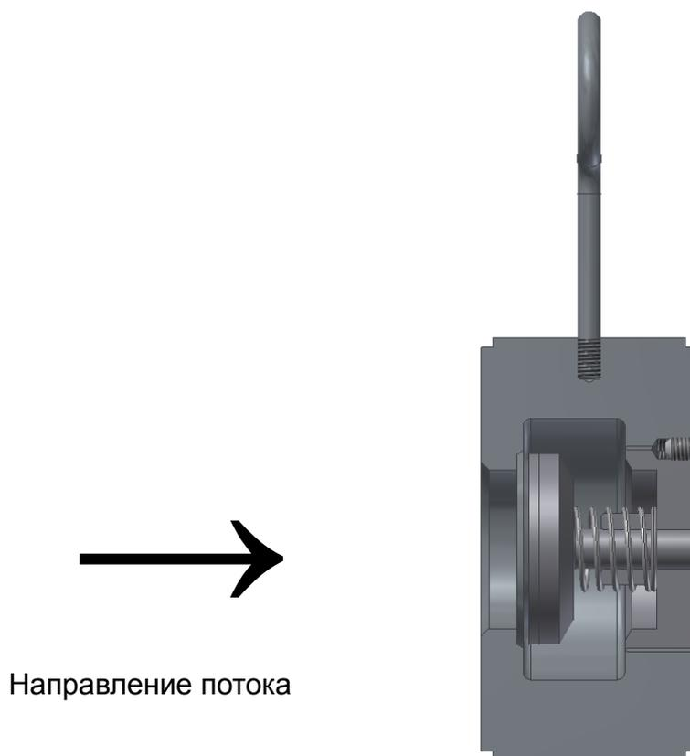
**Рис. 2 Допустимое монтажное положение**
