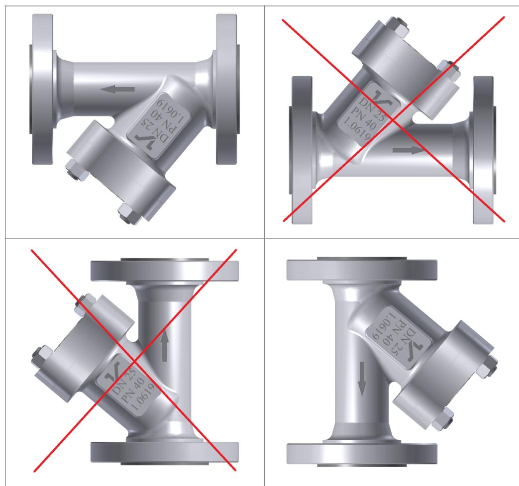
**Рис.2 Рекомендуемое монтажное положение**
